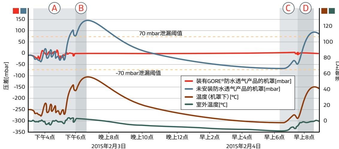
通过实车测试进行详细说明：对比装有防水透气产品与未安装防水透气产品的机罩中的热循环效应
