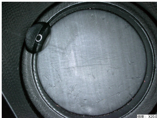
图1-8. 一部分安装在车灯壳体切割件上的防水透气产品未能通过eWEP测试
