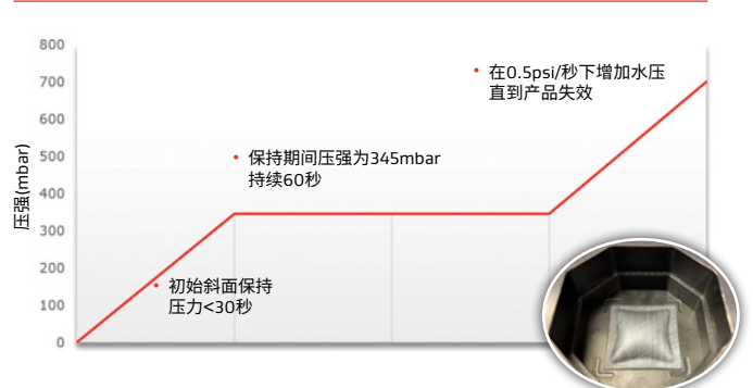
图3-5. 测量产品瞬时耐水压所采用的QATM 725台阶斜面方案
