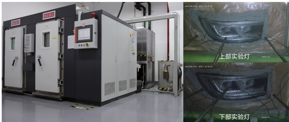
图1-10. 双环境测试箱（DCC）及测试场景
