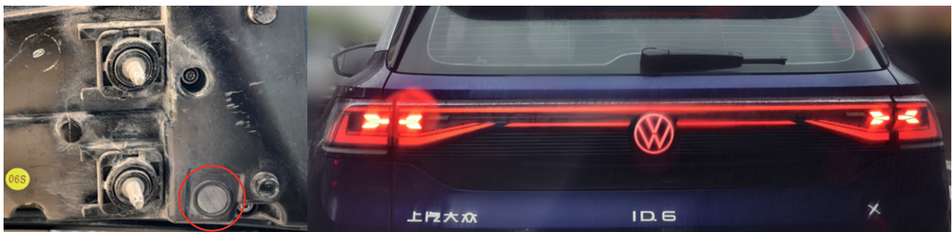
图1-15. 上汽大众ID.6 X在尾灯中采用了戈尔防水透气膜方案（从图中红圈标注可见，防水透气膜的实际应用环境和工况恶劣，对产品的可靠性提出更高要求）
