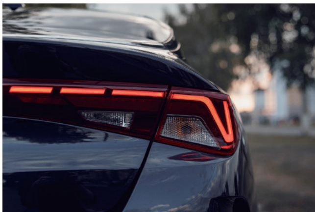
图1-4. 正在展示动态图案的OLED尾灯，极大便利和周围行人交互
