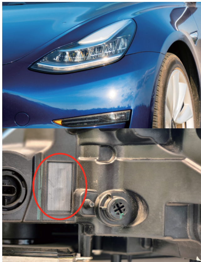
图1-6. 戈尔防水透气膜（如图中红色线圈标出）应用于Tesla Model 3大灯当中
