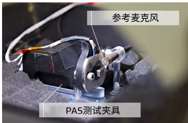
图1b: 安装在消音箱内并带有参考麦克风的PAS测试夹具
